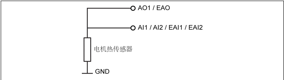
插图 12-60: 使用电流源的温度传感器
